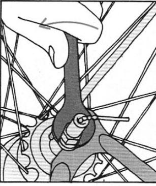
4 For at opnå fuld justering af kæden løsnes baghjulets motrikker, og hjulet skubbes fremefter – så langt det er forsvarligt
